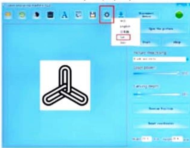
2. Intenzitu pohotovostního laseru 0-100 lze nastavit pro usnadnění pozorování nejmenšího jasného bodu.
