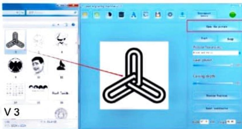
3. Prvním krokem je kliknout na pozici náhledu, zobrazit náhled rozsahu sochy a přetažením obrázku upravit polohu sochy. Ve druhém kroku je výkon laseru obecně nastaven na 100 a hloubku řezby lze upravit nastavitelná od 0 do 100 v závislosti na řezbářském materiálu. Třetí krok, po úpravě minimálního ohniska laserové hlavy, klikněte na start a začněte tesat!
